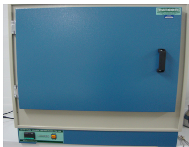
Figura 3: Estufa com circulação de ar, usada no experimento
