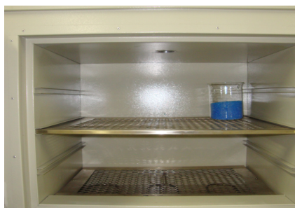
Figura 3: Estufa com circulação de ar, usada no experimento
